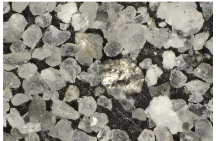
Mineralkörner nach Auflösung des Karbonat reichen Zements (Quarz, Feldspat, Glimmer)
